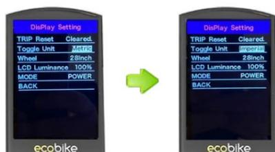
Einheit umschalten bedeutet, die Maßeinheit einzustellen. Um die Einheit zu ändern, drücken Sie die „+“-Taste oder die „-“-Taste, um die gewünschte Einheit auszuwählen, und drücken Sie dann zur Bestätigung die „i“-Taste. Um die geänderte Einstellung zu speichern, drücken Sie die „i“-Taste. Die Standardeinheit ist "Metrisch (km)".
