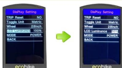
Die LCD-Luminanz gibt die Helligkeit der Display-Hintergrundbeleuchtung an. Um die Helligkeit der Hintergrundbeleuchtung zu ändern, drücken Sie die „+“- oder „-“-Taste, um den gewünschten Wert auszuwählen. Um die geänderte Einstellung zu speichern, drücken Sie die Taste „i“ - Der Standardwert ist 100 %.
