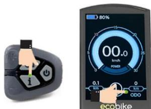
Wenn das elektrische System eingeschaltet ist, zeigt das Display die Geschwindigkeit und Entfernung als Standardwerte an.
