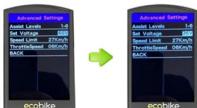
Set Voltage zeigt die Einstellungen des Batteriespannungsbalkens (Batteriestand) an. Geben Sie nacheinander 5 Spannungswerte ein.
